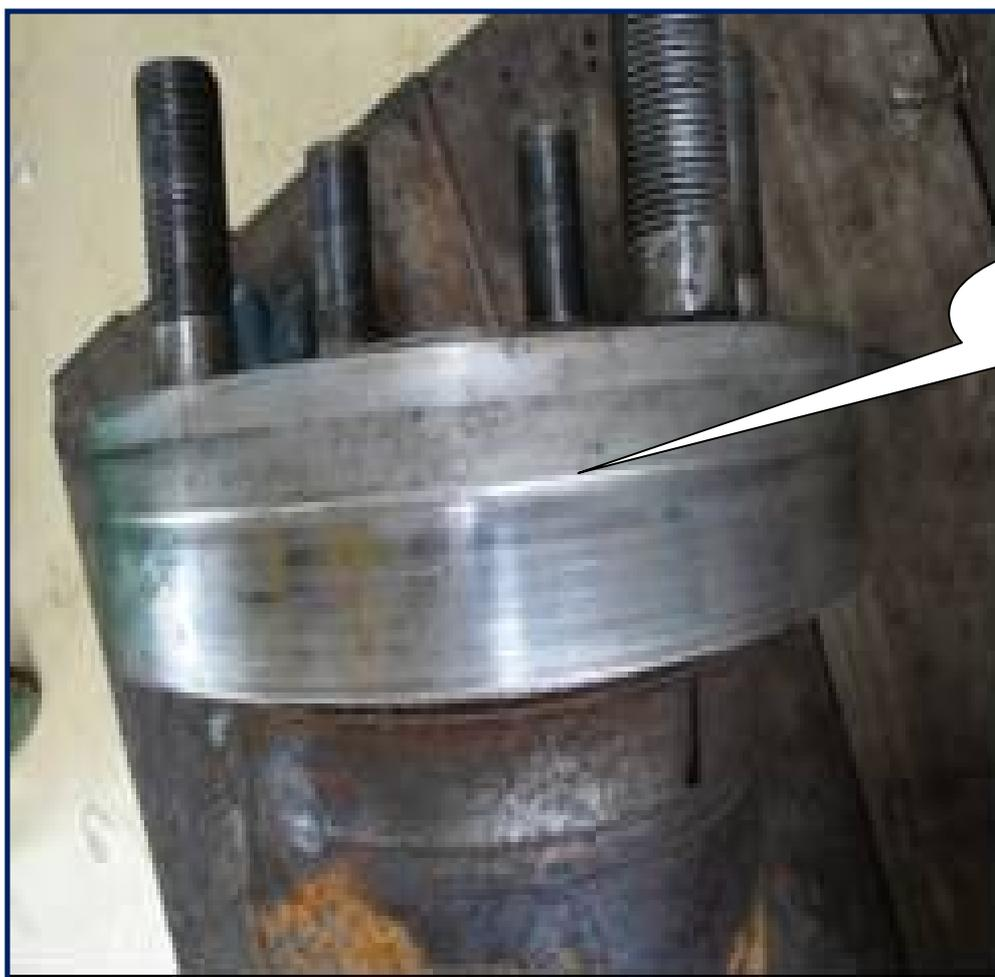
**FOTO 7:** Vista del eje árbol de acople. Se observa desgaste producido en el eje por la acción del empaque en caucho (posee internamente un anillo de fijación del empaque en acero inoxidable) que sella en este punto del eje con el plato superior.
