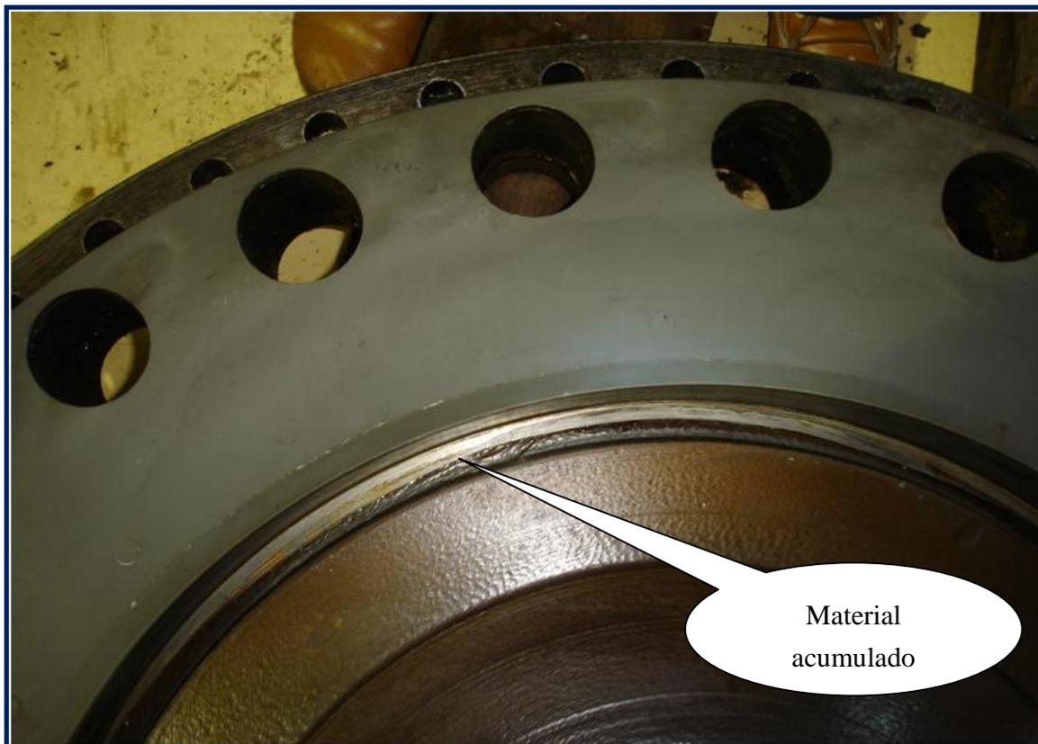
**FOTO 4:** Vista del plato superior de la turbina. La tapa de desgaste intentó desprenderse del plato. Se observa la acumulación de material producto de la fricción de la turbina con el anillo de sello hidráulico.
