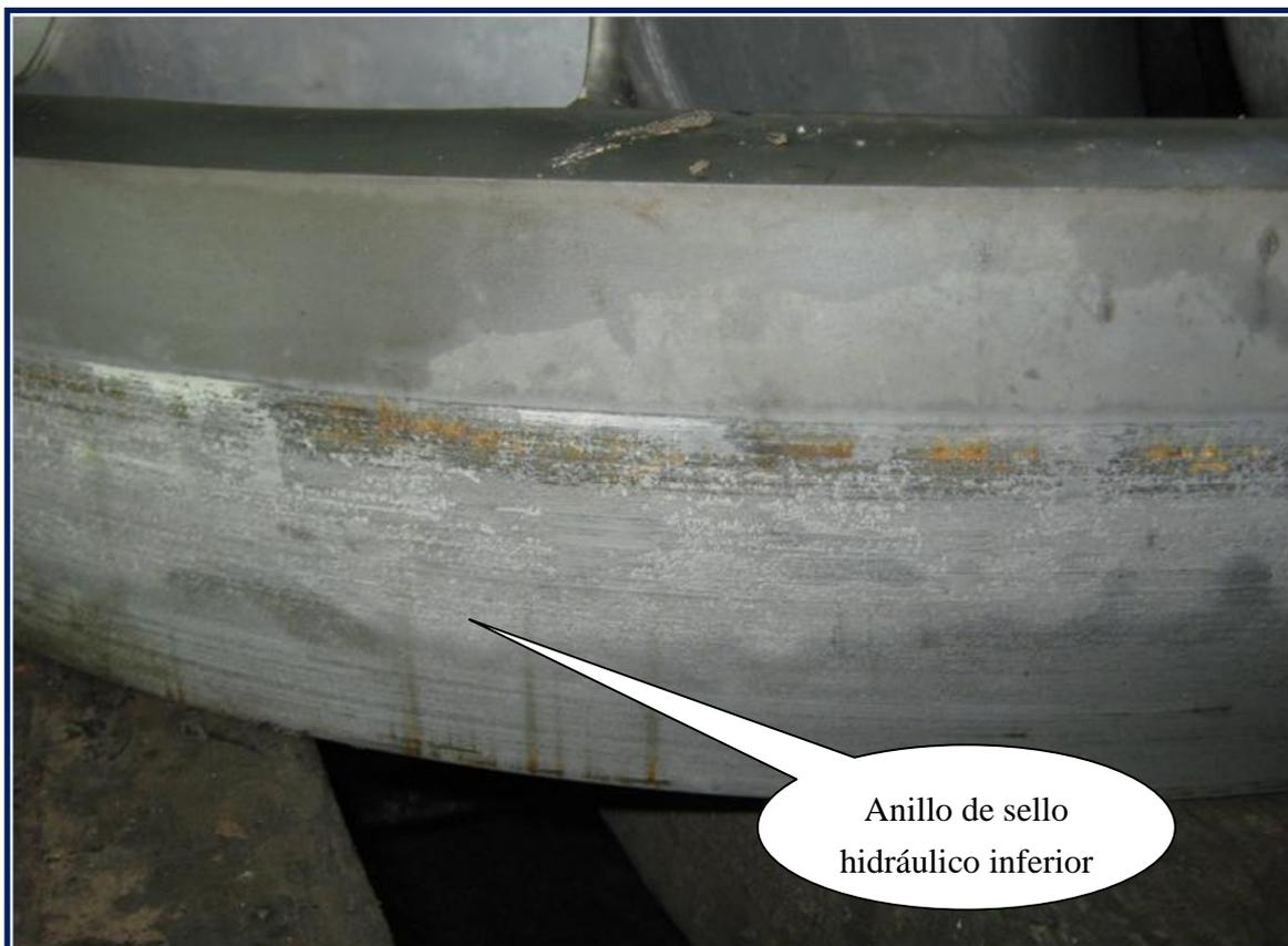
**FOTO 3:** Vista del anillo de sello inferior de la turbina. Esta fotografía corresponde al estado en el que se encuentra el diámetro mayor de la turbina. Se observa desgaste por fricción.
