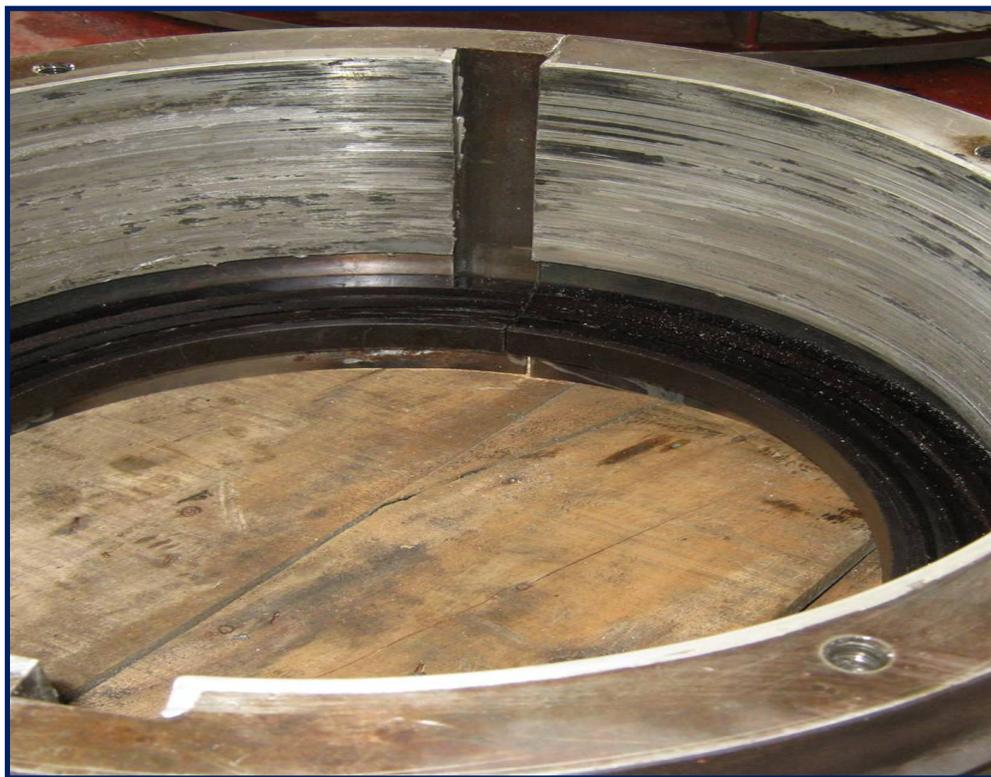
**FOTO 6:** Vista completa del cojinete guía del generador. Esta fotografía corresponde al estado en el que se encuentra el material Babbitt del
