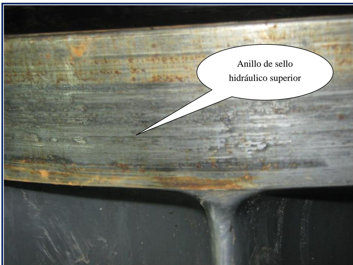
**FOTO 2:** Vista del anillo de sello superior de la turbina. Esta fotografía corresponde al estado en el que se encuentra el diámetro menor de la turbina. Se observa desgaste por fricción.
