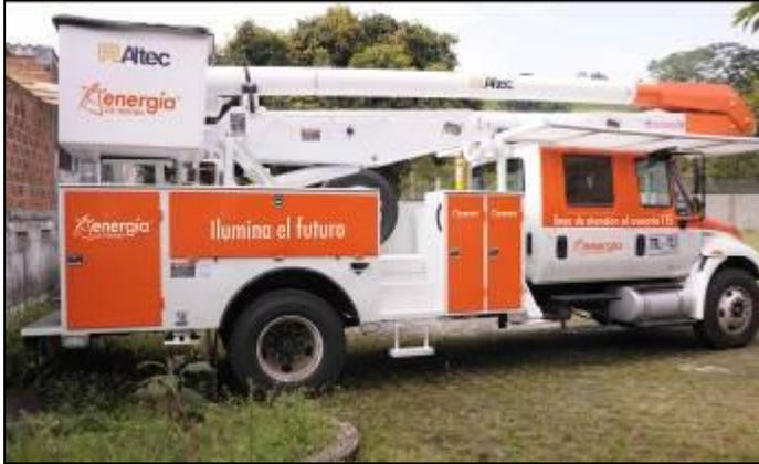
Con una inversión de 500 millones de pesos la Empresa de Energía de Pereira cuenta hoy con un nuevo Carro Canasta Aislado modelo 2014, con capacidad de aislamiento de 46 kV, un brazo articulado que permite un giro de 360° para mayor maniobra en redes de media tensión, y la más moderna herramienta para atender el exigente trabajo en línea viva.
